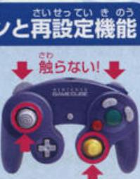
本体の電源をONにしたときの、これらのスティックやトリガーボタンの位置を「ニュートラルポジション」と呼びます。このときに各スティックが傾いていたり、各トリガーボタンが押されていた場合、その状態がニュートラルポジションと設定されてしまいます。このようにニュートラルポジションの位置がズレた状態では、正常な操作ができなくなります。
