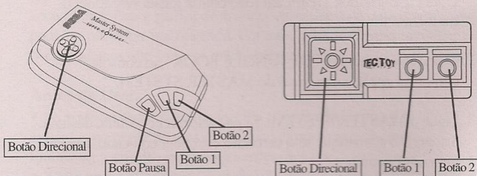
O Mogli é controlado pelo Joystick. Pressione o Botão D para a esquerda e para a direita para mover Mogli na direção correspondente. Pressione o Botão D para cima e para baixo para mover a Tela para que se possa ver o que há acima e abaixo.
